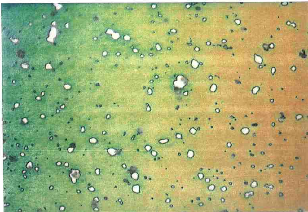
Figura 12 – Micrografia da amostra temperada após curva de polarização, apresentando leve ataque. Aumento: 1000x.
